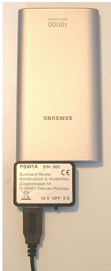
Das Powerpack gibt üblicherweise nur eine Spannung von 5 V ab, die nicht für den Betrieb des sPocket genügt. Moderne Geräte unterstützen jedoch verschiedene Modi mit erhöhter Abgabeleistung. Diese werden meist mit „Fast Charge“ oder „Quick Charge“ in verschiedenen Versionen bezeichnet. Für den sPocket wird ein Powerpack benötigt, das an einem USB-A Ausgang (Buchse) 12 V mit min. 1,0 A abgeben kann.
