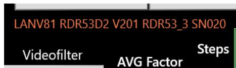
Bedeutung im Beispiel-Bild oben: (W)**LAN**-Treiber **V81** in Gerät **RDR53** (sPocket) Typ **D2** mit Firmware **V201** und Bedienoberfläche **RDR53\_3**, Serien-Nummer **020**.
