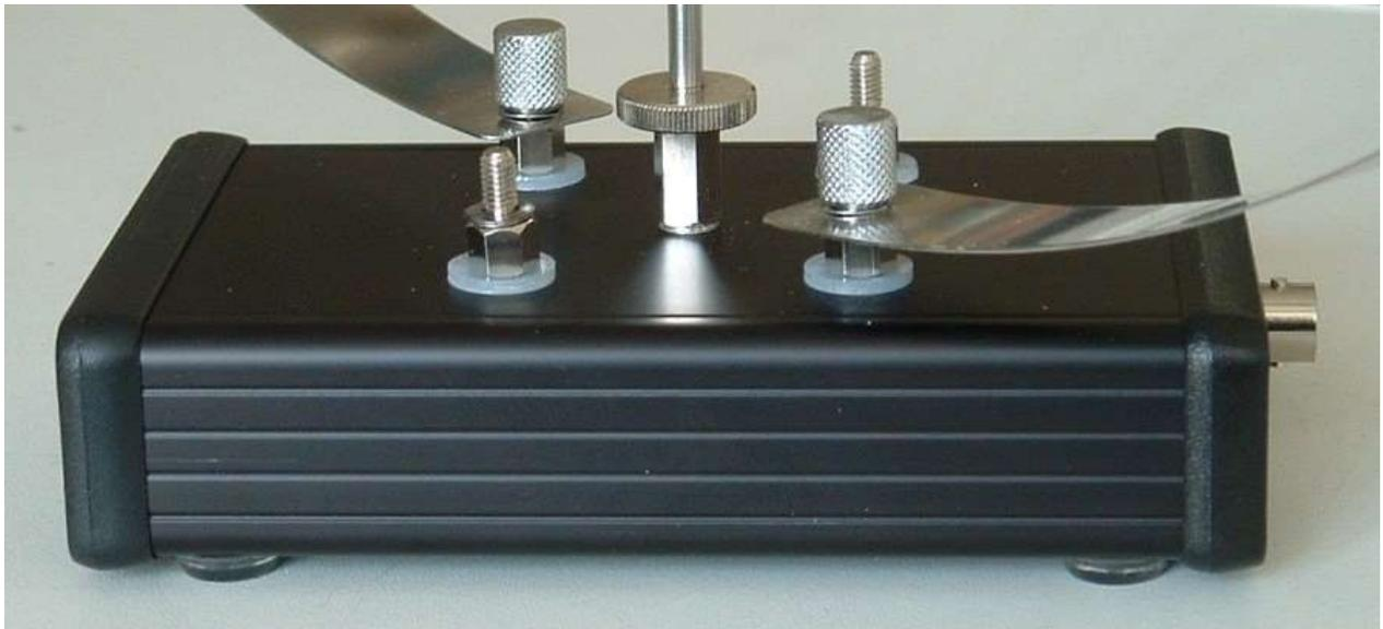
**Anschlussbolzen des Verstärkers mit einem montierten Stahlstreifen**
