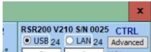
Stimmen beide Nummern nicht überein, muss entweder die passende DLL verwendet, oder die passende Firmware in den RSR200 geladen werden. Üblicherweise sollten beide Teile auf den Stand der neuesten Version gebracht werden.
