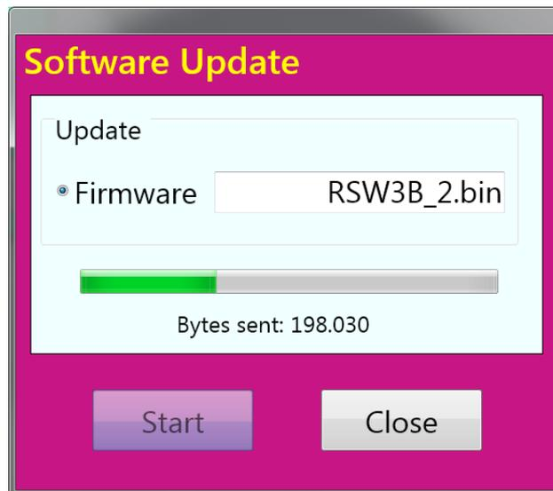
Das Feld „Firmware“ ist zunächst leer. Mit Doppelklick / -tipp darauf sucht das Programm nach ladbaren Dateien. Diese müssen immer die Erweiterung .Bit haben und sich direkt im Ordner der ExtIO\*.DLL befinden. Sollten mehrere \*.Bit Dateien im Ordner existieren, wird die erste auffindbare (je nach Anordnung der Dateien im Ordner) verwendet. Um Verwechslungen zu vermeiden, sollte also immer nur eine, nämlich genau die zu ladende (neue) Firmware im Programmordner vorhanden sein.
