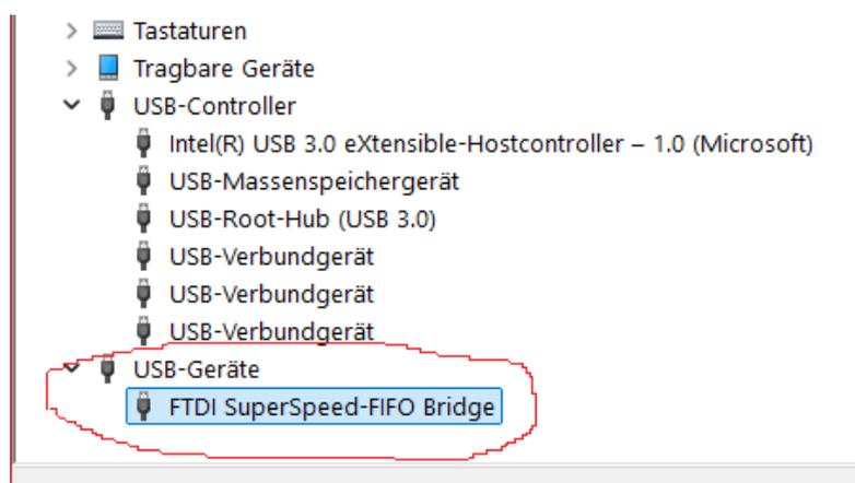
Der neue „WU“-Treiber kann im Gerätemanager nach Öffnen der Eigenschaften für den bisherigen FT601 Eintrag unter „USB-Controller“ angegeben werden. Nach Aktualisierung des Treibers kann für das SDR-Programm nur noch die FTD3XXWU.DLL (und die zugehörige ExtIO\_RSR200B210.DLL) verwendet werden. Die alten DLLs können gelöscht werden, nachdem der neue Treiber zuverlässig läuft.
